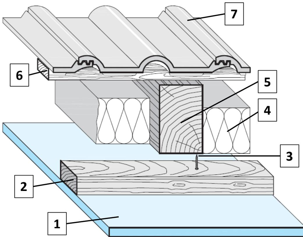
1 Gipskarton-Bauplatte (GKB), d = 12,5 mm
